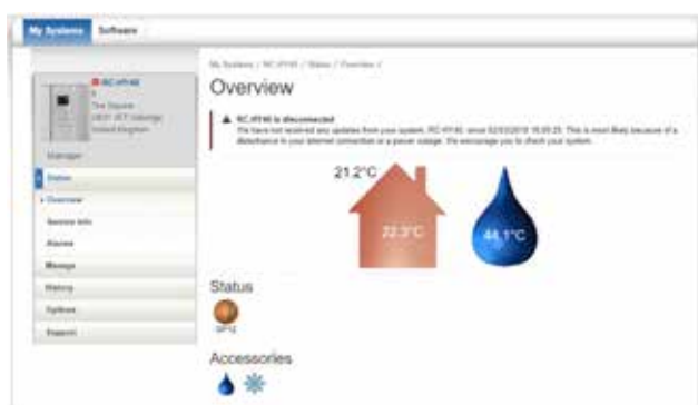
Prikaz trenutnega stanja: sobna temperatura, temperatura sanitarne vode, opozorila
